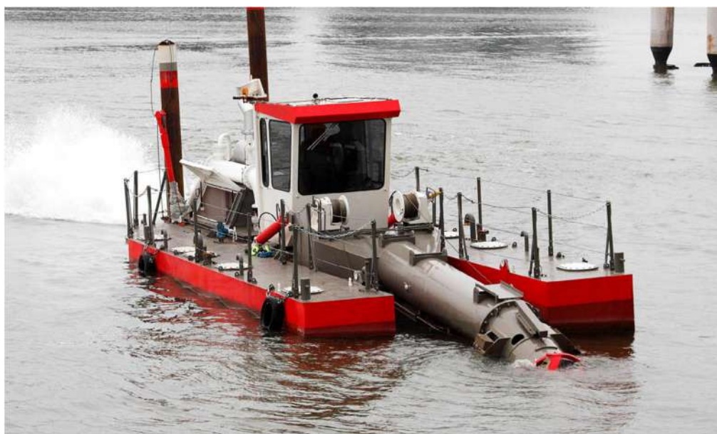
Figura 6-46: Draga adotada para atuar na zona 2 (alternativa 2) - IHC Beaver 30
