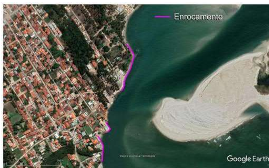
Figura 5-41: Erosão da margem esquerda na entrada do canal. As linhas roxas indicam áreas protegidas por enrocamentos.
