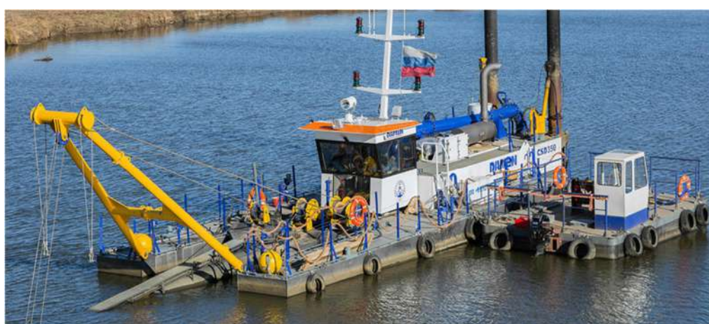
Figura 6-31: Draga adotada para atuar na zona 1 - DAMEN CSD350
