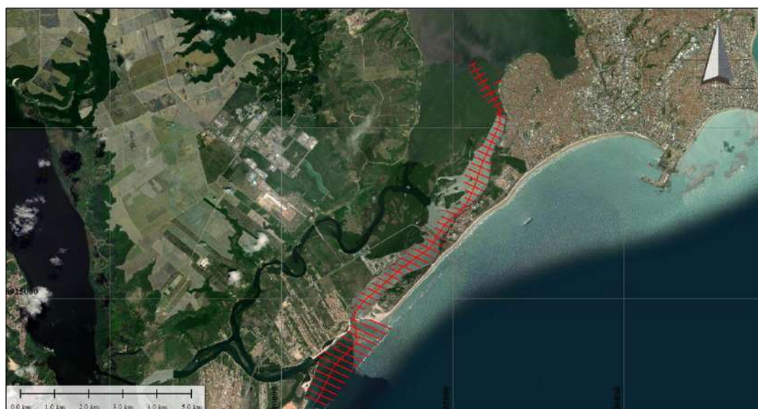
Figura 4-2: Área do levantamento no canal e malha de aquisição planejada em vermelho.
